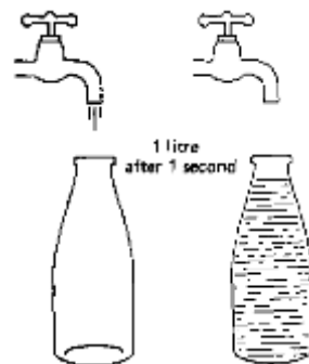
Слика 2-2 Стапка на проток од еден литар на секунда
